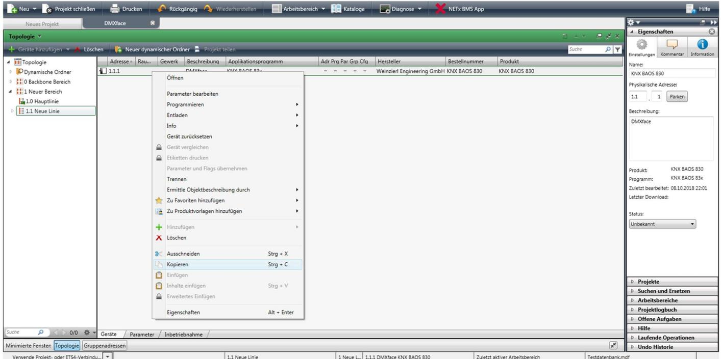
Ins Zielprojekt wechseln (Dabei das DMXface Projekt nicht schließen!) und dort an die gewünschte Einfügeposition (Topologie oder Gebäudeansicht) springen und mit STRG + V (oder Rechtsklick "Inhalte Einfügen") das DMXface Gateway einfügen.
