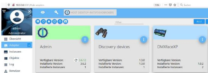
Im nächsten Schritt klicken Sie auf die 3 Punkte am DMXfaceXP Adapter. Und betätigen Sie das + Symbol um eine Instanz hinzuzufügen. Ein Fenster zum Konfigurieren der Verbindung zum DMXface wird geöffnet.
