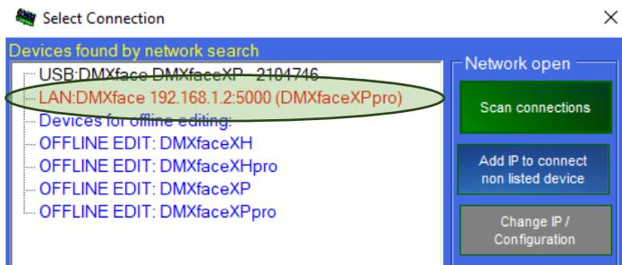
Ist der Controller rot aufgelistet liegt das daran, dass sich das Gerät außerhalb der IP-Range befindet und nicht ausgewählt werden kann. Ist die Schriftfarbe schwarz kann der Controller per Click verbunden werden.
