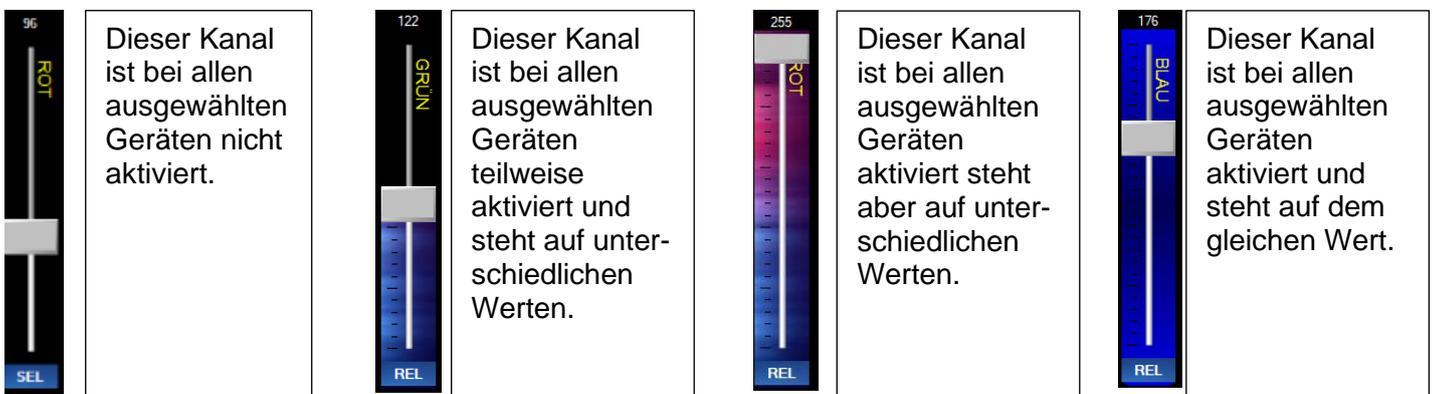
Der SEL / REL Button an dem Fader ermöglicht es die DMX-Kanäle dahinter alle zu aktivieren oder zu deaktivieren.
