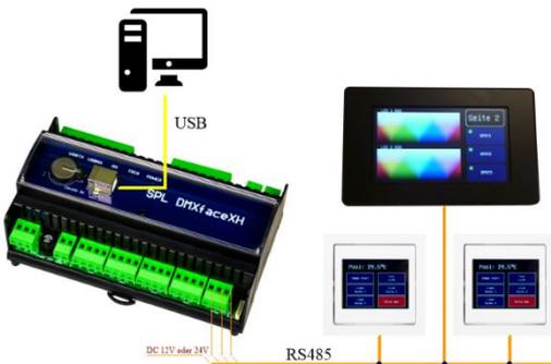
Dieser BUS ist primär zum Anschluss von LCD-Displays vorgesehen.
