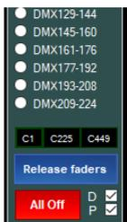
Da diese Controller mit 544 DMX-Kanälen arbeiten, werden im unteren Bereich des DMX Control Feldes drei zusätzliche Buttons zum weiteren Umschalten der Kanalbanken angezeigt.
