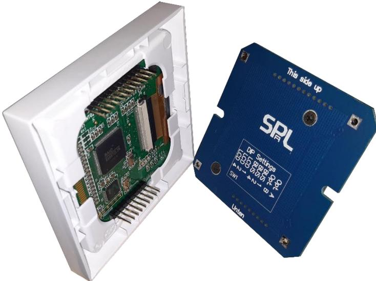
Die Anschlüsse GND, D- und D+ werden 1:1 mit dem RS485 Stecker am DMXface verbunden.
